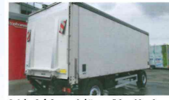
2-Achs-SafeServer-Anhänger, 7,3 m, 18 to Ges.Gew., Dekra-zertifiziert, Hebebühne, EZ 09
